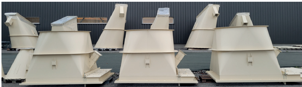
Embases sous silo
